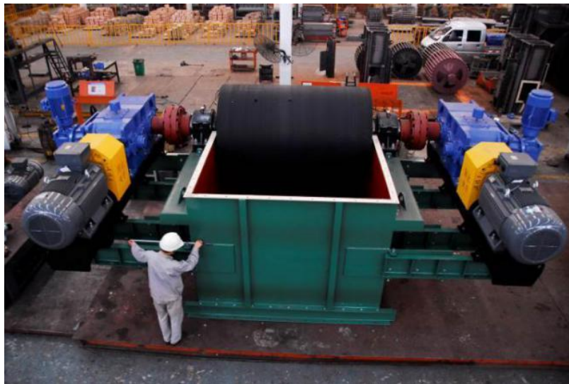
图 3 N-TGD2000 型钢丝胶带斗式提升机机头
